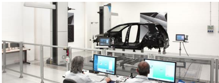
Figur 47: Hexagon mätmaskin för utveckling av fordonsstrukturer. Källa: Hexagon
