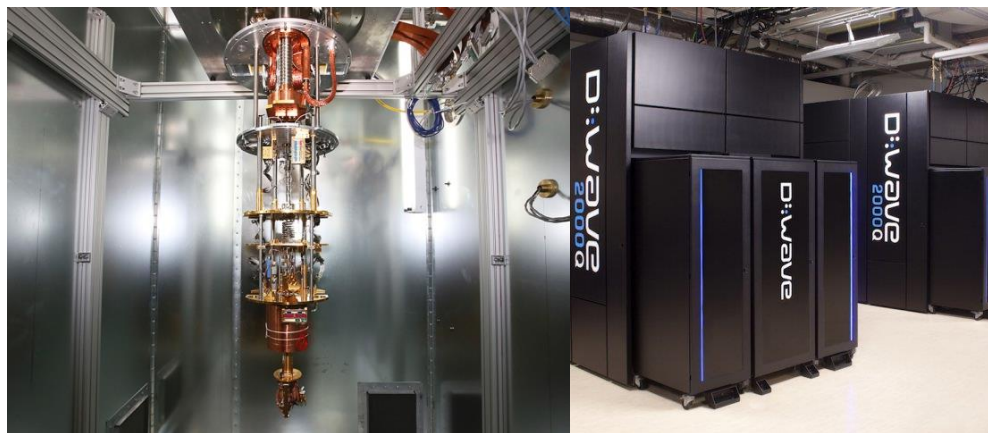
Figur 23: D Wave Systems kommersiella kvatdator D-Wavves 2000Q. Processorn till vänster. Källa: D-Waves
